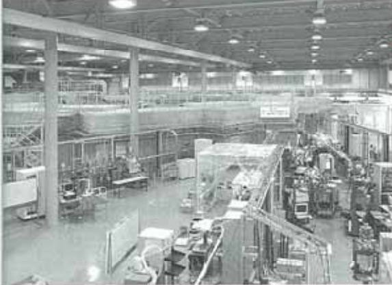
今年2月に鳥栖市にオープンした佐賀県立九州シンクロナン光研究センターの実験ホール。光源装置により発生したシンクロナン光が「ビームライン」により実験装置に導かれ、分析・解析などの実験を行う。
